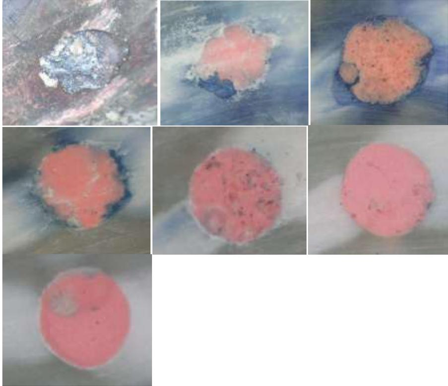
*Fotografías de una de las raíces obturadas con el cemento sellador Sealapex seccionadas vistas con estereoscopio , nótese que la primera imagen esá completamente teñida y es porque es la parte exterior la cual estuvo en contacto con el azul de metileno, y las siguientes 5 imágenes muestran la filtración que hubo que corresponden a 5 milímetros. La última imagen es del último corte realizado que nos sirve como testigo de ausencia de filtración.*
