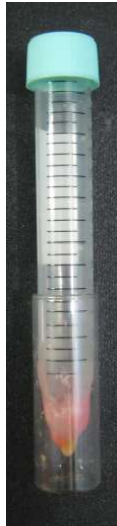
Colocación de recipiente de vidrio en el tubo Falcon con diente sellado con acrílico y cera
