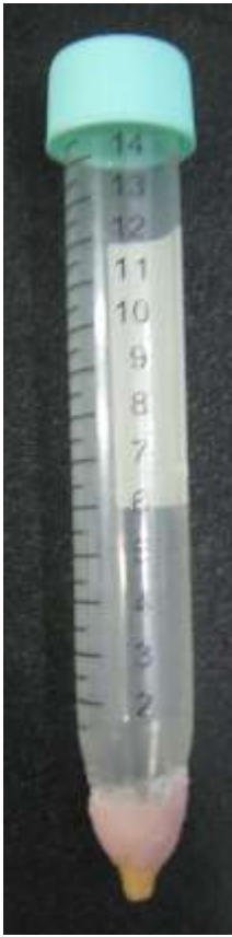
Unión y sellado de diente con acrílico al tubo Falcon
