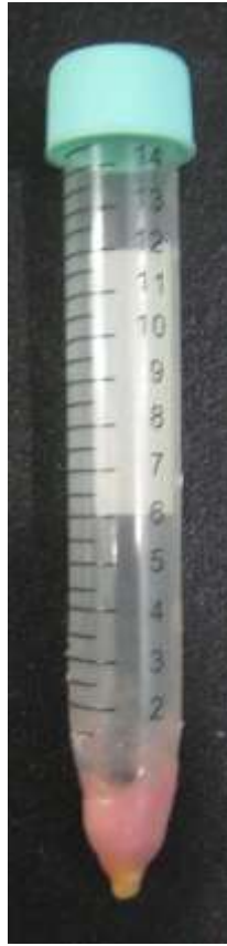
Unión y sellado de diente con acrílico y cera al tubo Falcon
